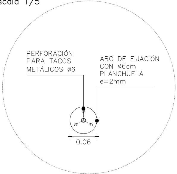
DETALLE PLATINA DE AMURE EN PARED escala 1/5
