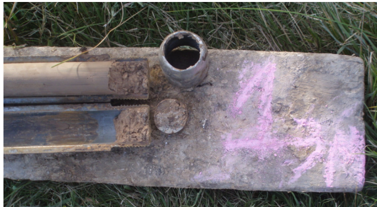
CATEO 1, ENSAYO S.P.T. a 3.0 m ARCILLA DURA CON CARBONATOS
