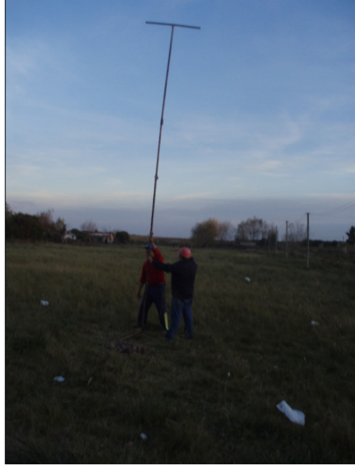
CATEO 1, ENSAYO S.P.T. a 3.0 m ARCILLA DURA CON CARBONATOS
