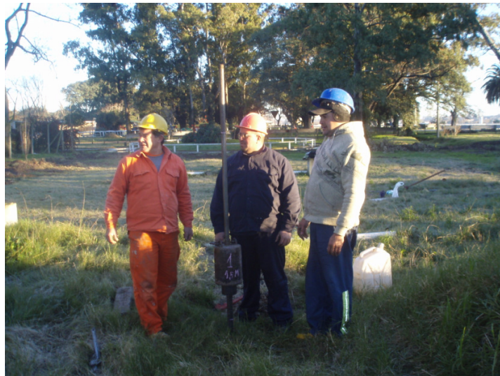
MUESTRAEDOR DE "TERZAGHI" ARCILLA MARRÓN Y EN PUNTA SUELO "TURBOSO"
