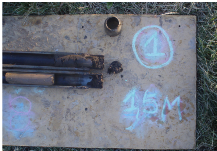
MUESTRAEDOR DE "TERZAGHI" ARCILLA MARRÓN Y EN PUNTA SUELO "TURBOSO"
